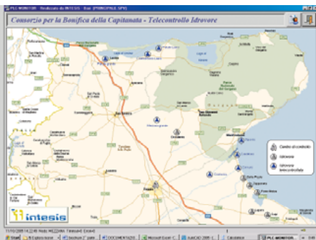
Fig.1. Telecontrollo degli impianti idrovori dell'intero Comprensorio1 (in blu le idrovore già controllate)
